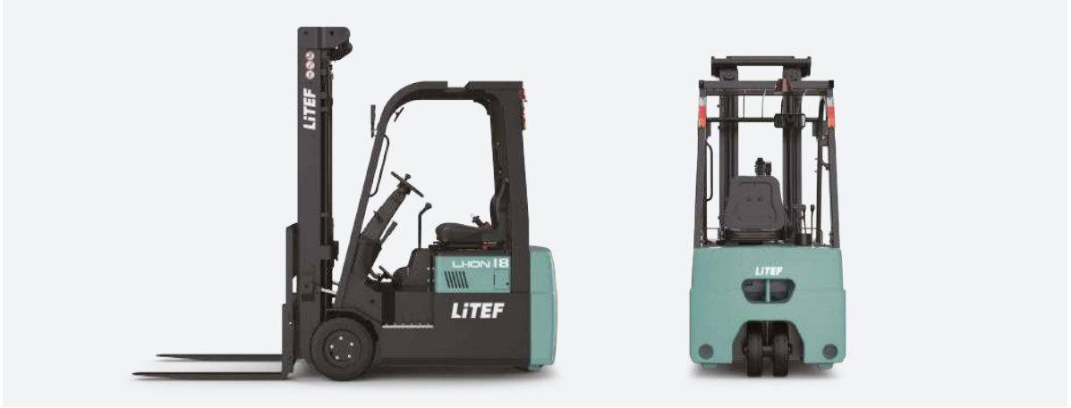
TVL181 Çatal Yüzüne Kadar Uzunluk: 1913mm(L2) Toplam Genişlik: 1070mm(b1/b2)
