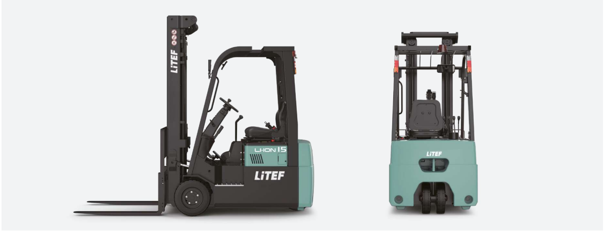
TVL151 Çatal Yüzüne Kadar Uzunluk: 1813mm(L2) Toplam Genişlik: 1070mm(b1/b2)
