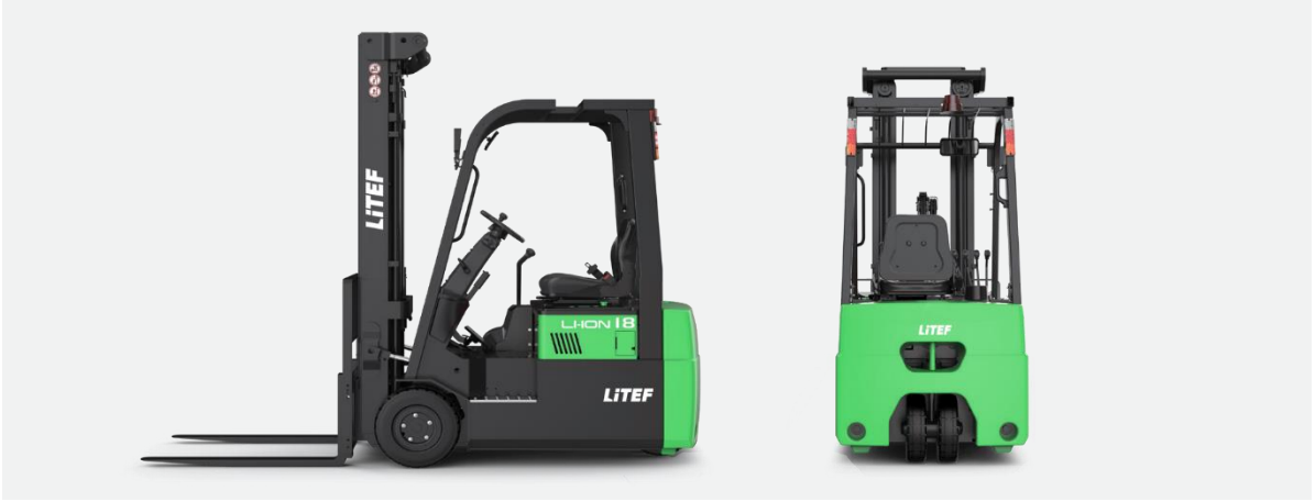
CPD18TVL Çatalların yüzüne kadar : 1913mm(L2) Genel: 1070mm(b1/b2)
